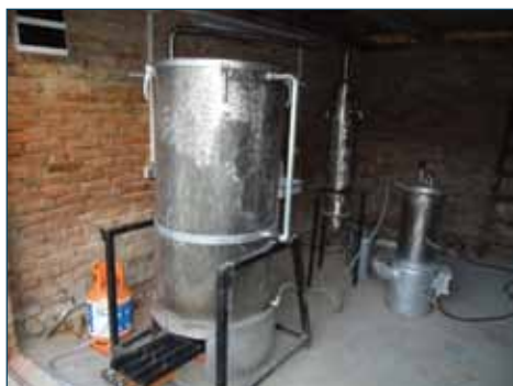
Slika 7. Parni destilator za dobivanje eteričnog ulja lavande/lavandina koji se nalazi na OPG-u na području Sisačko-moslavačke županije (izvor slike: autori teksta)
